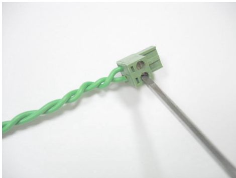
Figuur 1.16 - Draai de schroef vast zodat de draad in de connector vastzit
